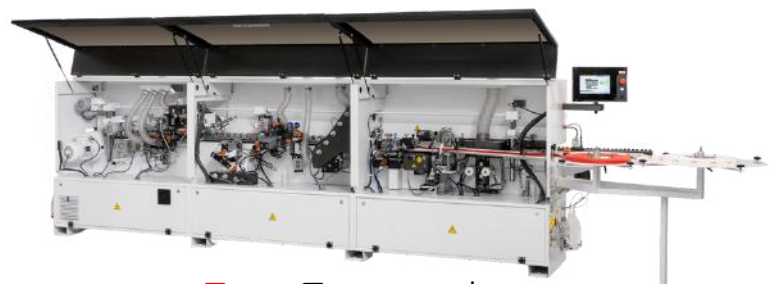
Pro Concept Velocidad de hasta 14m/min
