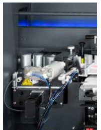
Base de rodillos con ajuste motorizado
