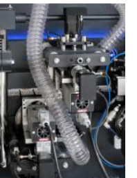
Grupo rellador con ajuste motorizado
