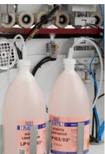
Estaciones de spray en la entrada, medio y salida
