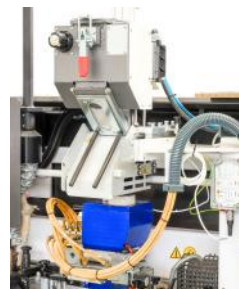
Calderín M22 con pre-fusor granulado
