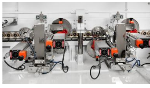
Doble grupo refilador (desbaste + acabado)
