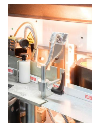
Lámpara infrarroja en la entrada y grupo de presión
