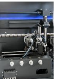
Grupo ribeador con ajuste motorizado
