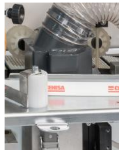
Tupí en la entrada con fresas DIA
