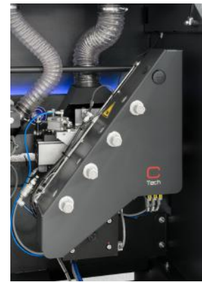
Retestador de 2 motores con inclinación automática
