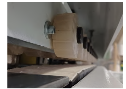
Pisador superior centralizado con doble hilera de ruedas
