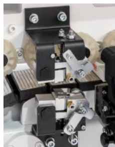
Rascador de cola w/ cuchillas flotantes
