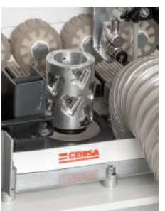
Cuchillas DIA intercambiables
