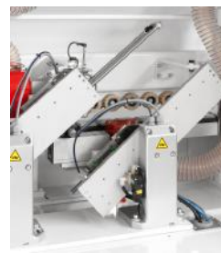
Retestador de 2 motores
