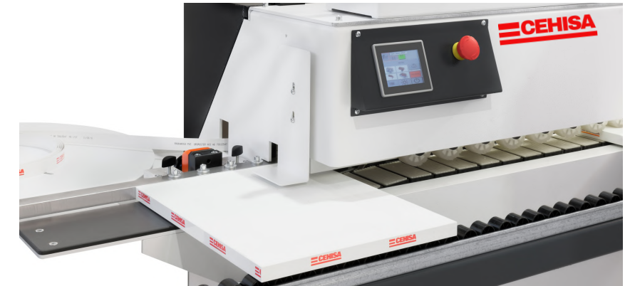
PLC Industrial con pantalla táctil 3,5"
