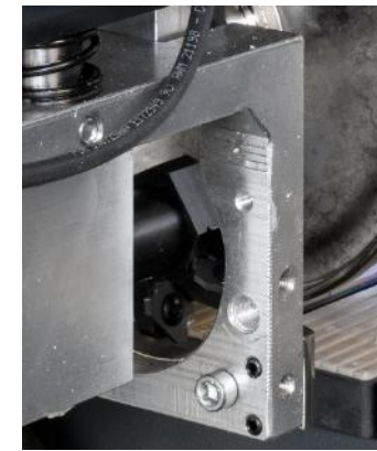
Rascador de radio con sistema automático de doble cuchilla
